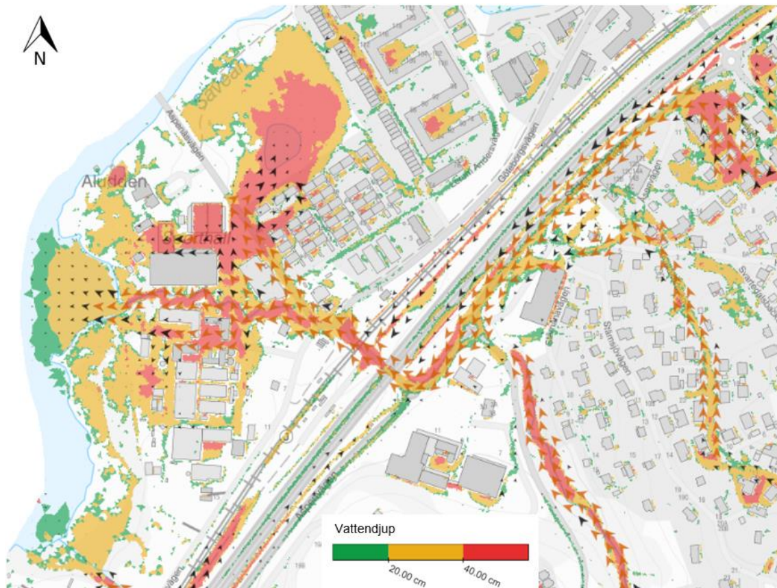
Figur 7. Maximalt vattendjup och rinnvägar vid ett klimatanpassat 100-årsregn med befintlig bebyggelse.
